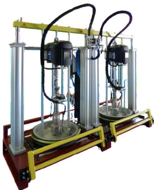
*Pompa a piatto premente doppia per fusti da 200 L con collegamento tandem e sensori di livello.*
